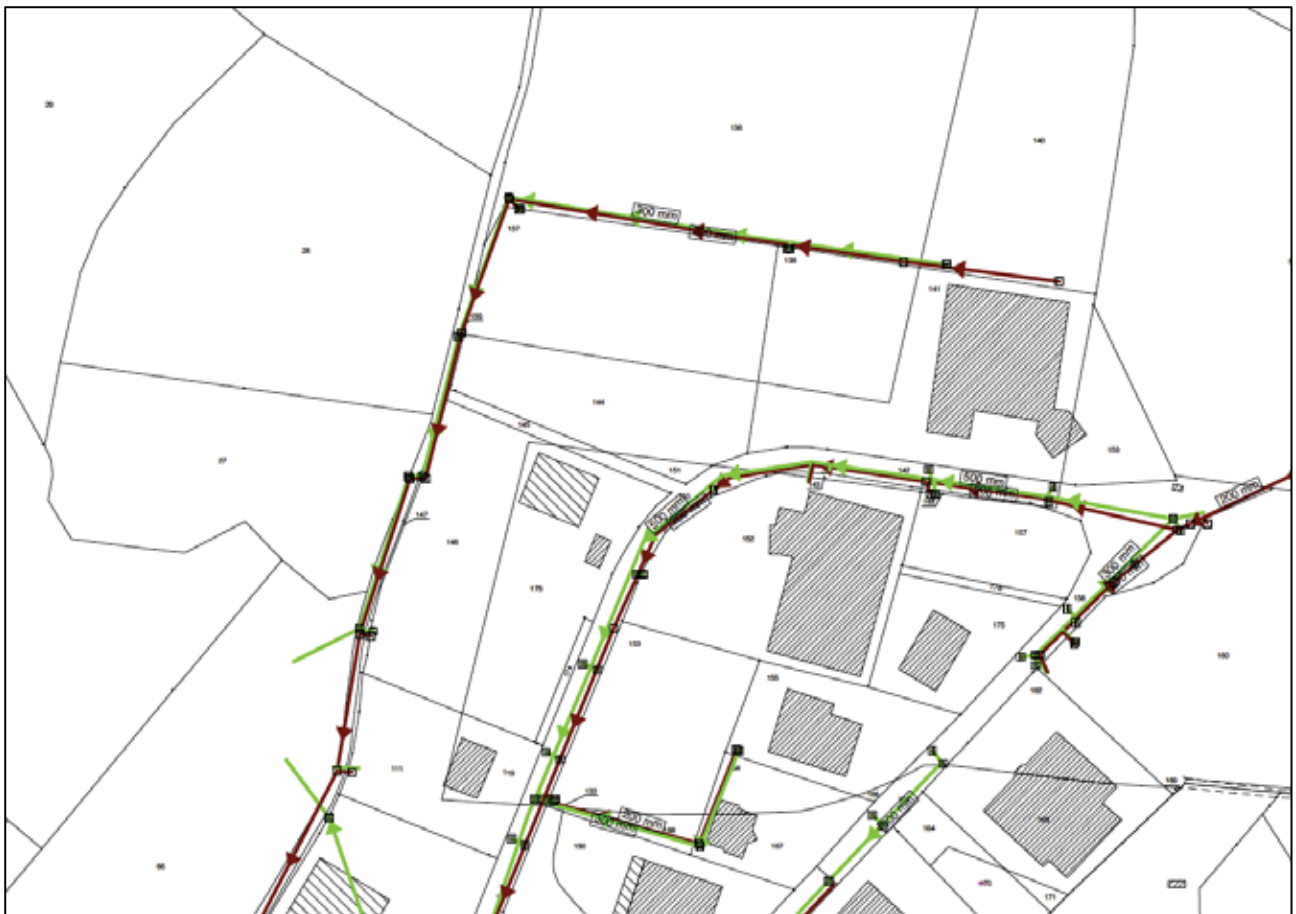
Extrait des plans des réseaux d'assainissement – source annexe du PLU de Davézieux
